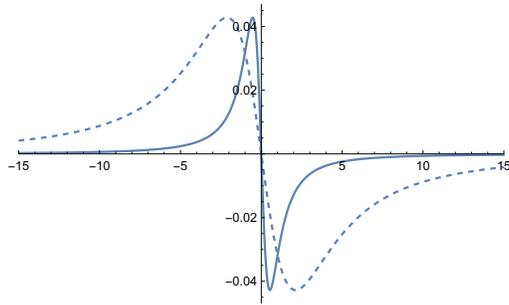
Allure du champ  $E_1$  en fonction de  $vt$ . En continu, cas  $\gamma = 4$ , en tireté cas  $\gamma = 1$ . On a arbitrairement posé  $q = 4\pi$  pour fixer l'échelle verticale.
