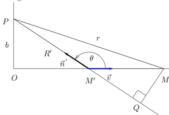
On note  $M$  et  $M'$  la position de la charge respectivement à l'instant  $t$  et à l'instant retardé  $t'$ .
