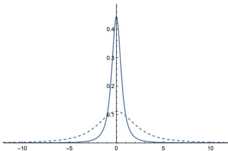
Allure du champ  $E_2$  en fonction de  $vt$ . En continu, cas  $\gamma = 4$ , en tireté cas  $\gamma = 1$ . On a arbitrairement posé  $q = 4\pi$  pour fixer l'échelle verticale.
